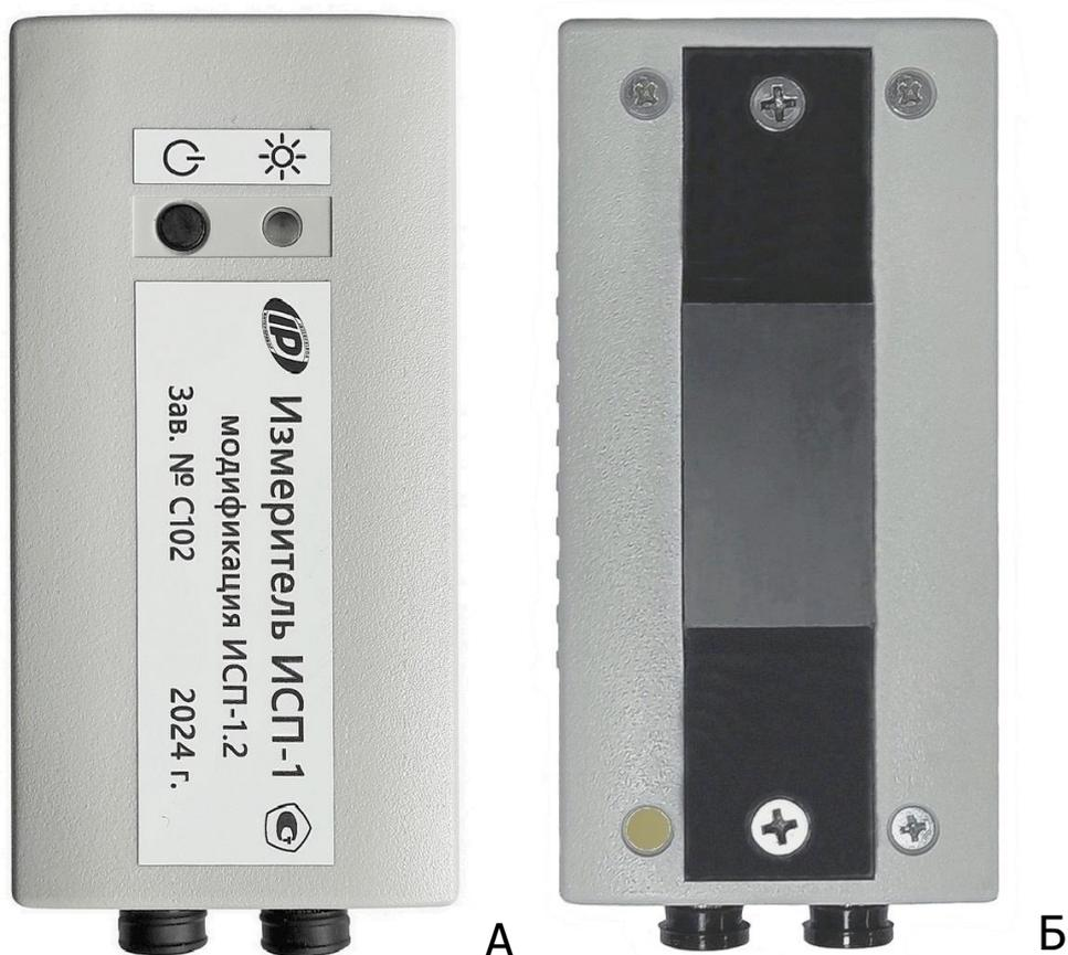
Рисунок 7 – Преобразователь сигналов ИСП-1
