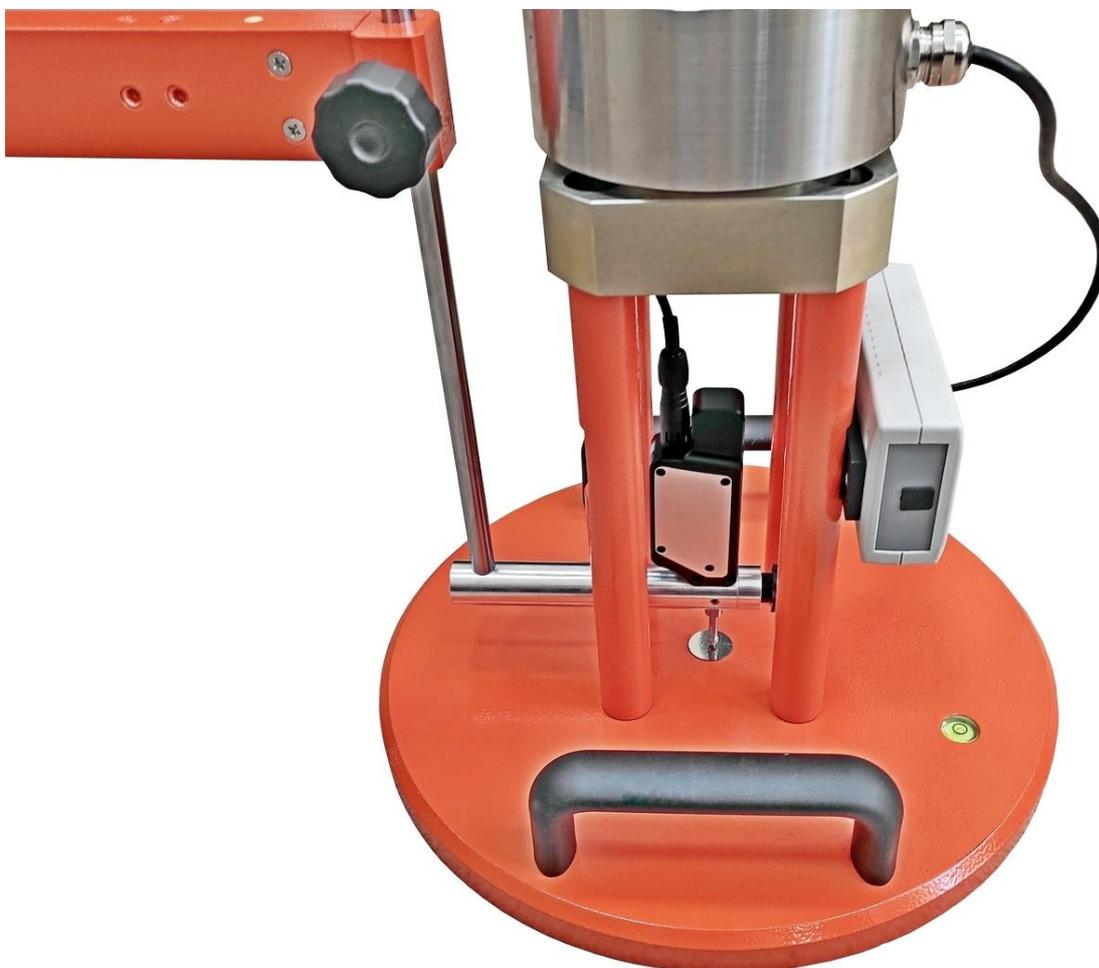
Рисунок 31 – Установка датчика перемещения
